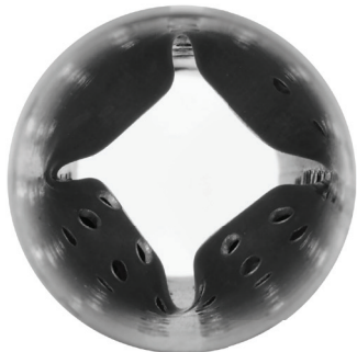
wnętrze strumienicy gwiazdkowej
